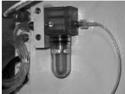
Figura 2. Trampa de agua en la entrada de la sonda al monitor a un analizador de gases side stream.
