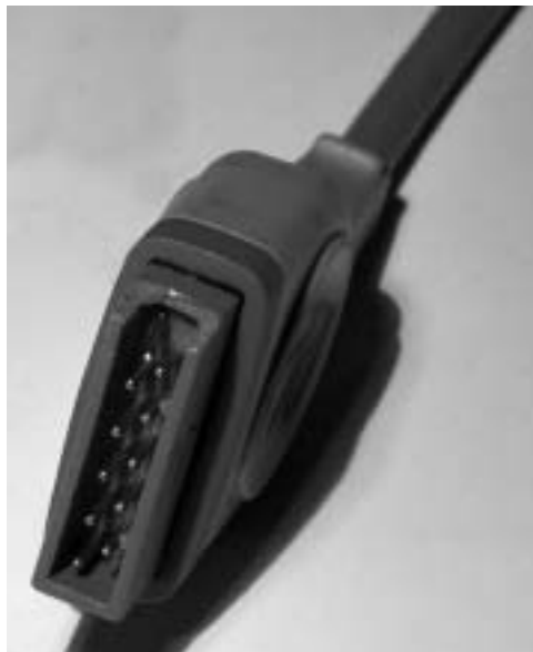
Figura 4. Conexión de un cable al cuerpo del monitor. Nótese que la conexión está rota y una patilla del conector está doblada.
